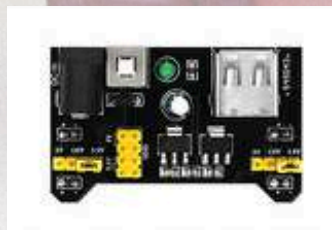
MODULO DE PODER/ALIMENTACIÓN
